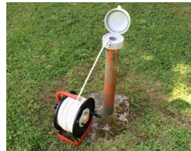
Exemple de piézomètre et de mesure du niveau de la nappe (SIGES/BRGM)
