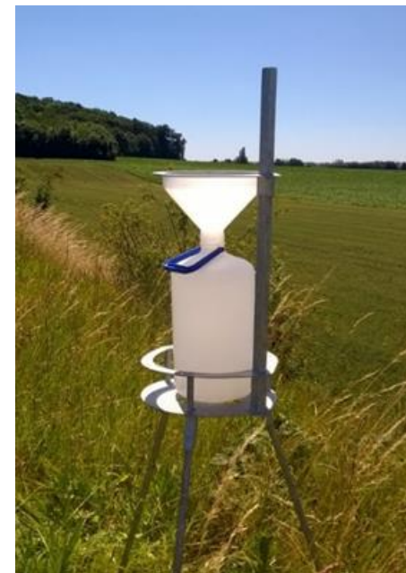
Exemple de jauge de mesure des retombées de poussières (ENCEM)
